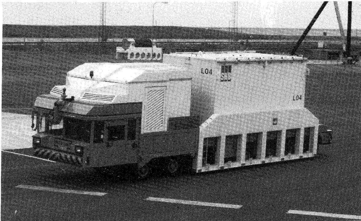
Figur 3.2 Terminalfordon med stålskyddande transportbehållare, ATB, för medelaktivt avfall
